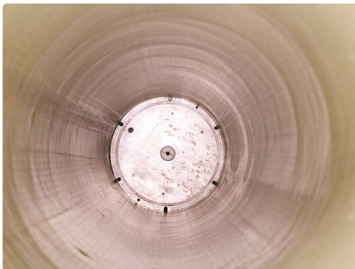
Proceso de curado por medio de luz UV permitiendo una dureza de 1,900 Kg/cm 2 .
